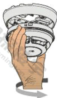
图 1 - 内部报警指示灯 (AI)居中，安装时无需对准方向
